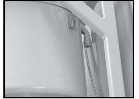
Adım 6. Ünitenin girişini uygun kanal ve adaptör kullanarak ekstraksiyon deliğine bağlayın (ayrı olarak verilir).
